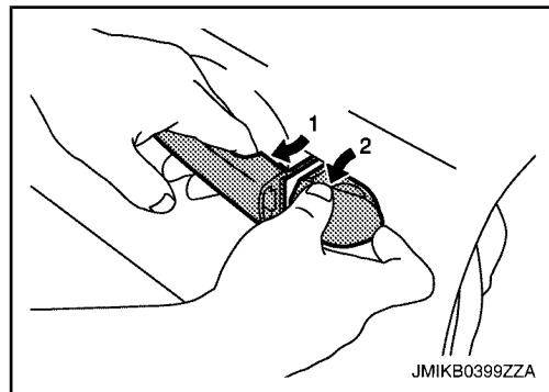
9. 如图所示, 按照 1→2 的顺序, 拉起外把手(1)时, 向车辆后方滑动以拆下外把手。
