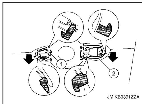
11. 如图所示，按照 1→2 的顺序，向车辆后方滑动外把手支架以拆卸。
