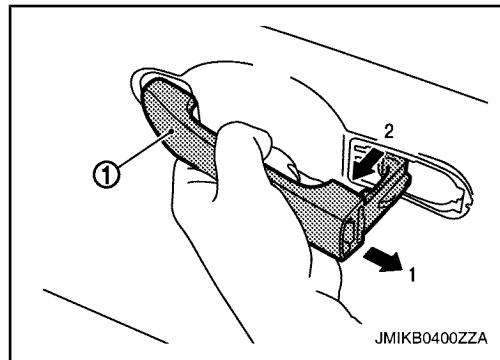
10. 拆下前部垫圈(1)和后部垫圈(2)。
